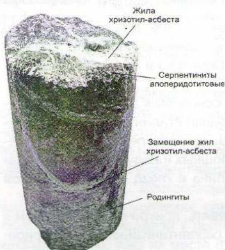
Рисунок 2 - Замещение жил хризотил-асбеста на контактах даек диоритовых порфириров (залежь Основная, линия 23 + 00, образец керна, скв. 42, гор. + 35 м)
