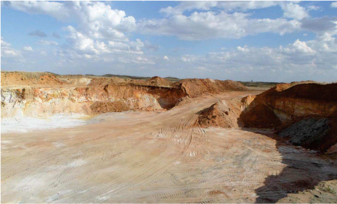
Панорама карьера Мариинского месторождения строительного песка
