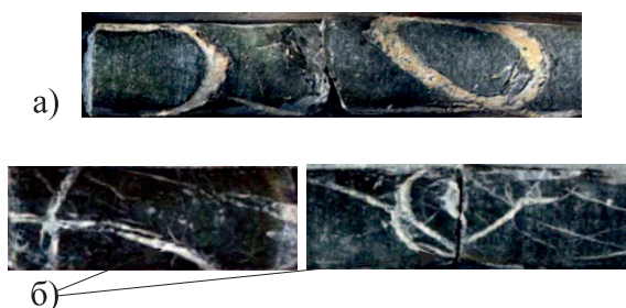
Рисунок 2 – Типы асбестоносности, выделенные на Киембаевском месторождении хризотил-асбеста из керна скважин колонкового бурения: а – крупная сетка, б – мелкая сетка
