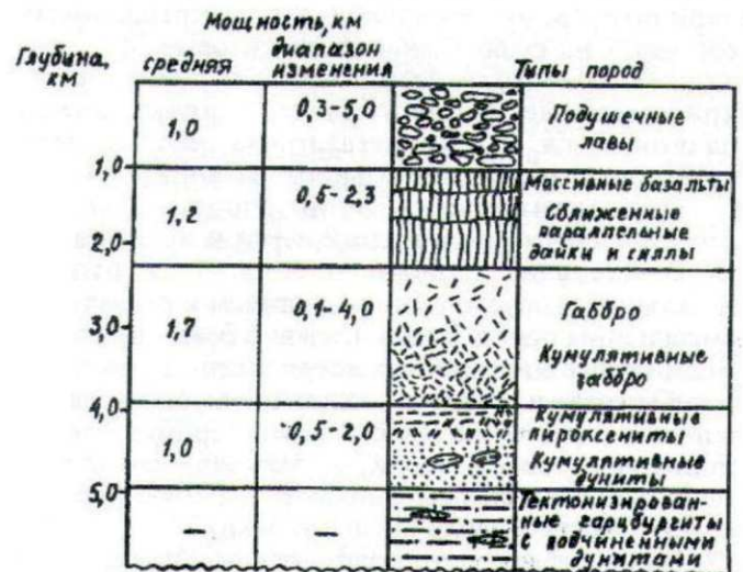
Рис. 4. Последовательность слоев магматических пород типичных офиолитов океанской плиты, степень метаморфического преобразования пород не отражена (по Клагью и Стрейли [17])
