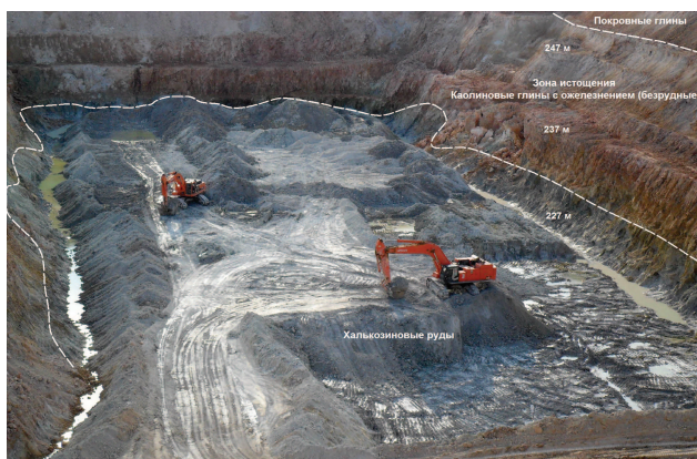
Рисунок 3 – Опытный карьер месторождения Бенкала. Видны зоны истощения и вторичного сульфидного обогащения (халькозиновые руды).
