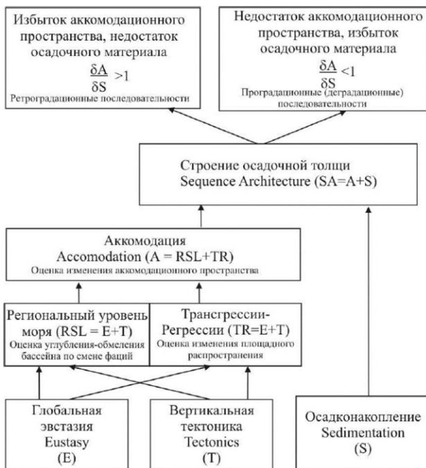
Рисунок 2 – Генерализованная схема, иллюстрирующая влияние эвстазии, вертикальной тектоники и осадконакопления на формирование различных типов осадочных последовательностей [18: по 19, 20 и др. с изменениями и дополнениями]
