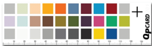
Рисунок – 6 Пример шкалы серых и цветных оттенков используемой для корректировки цветового баланса
