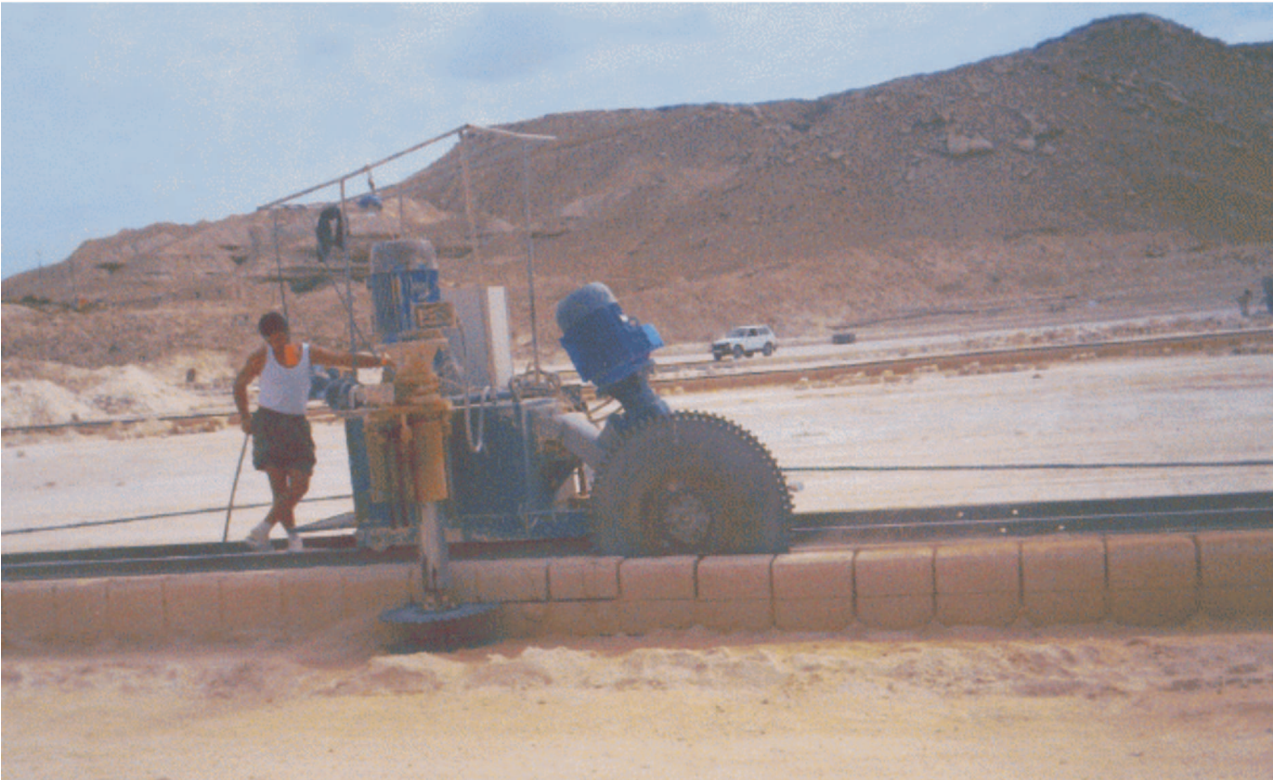
Рис. 3. Горизонтальная и вертикальная резка камней камнерезной машиной «Прима»
