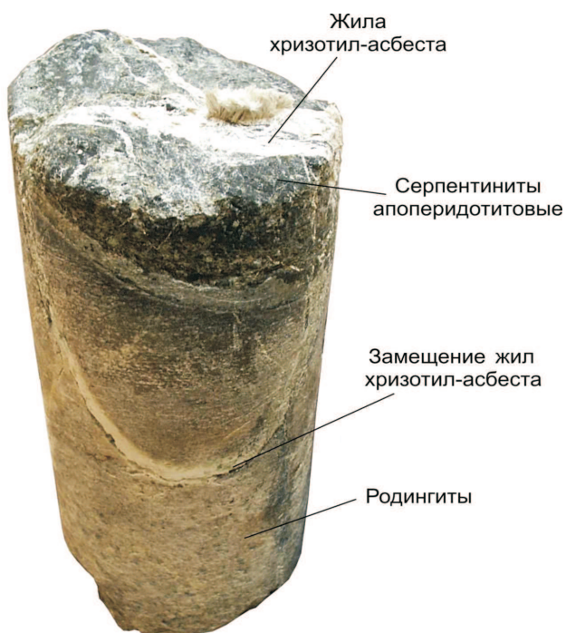
Рис. 11. Замещение жил хризотил-асбеста на контактах даек диоритовых порфиритов (залежь Основная, линия 23 + 00, образец керна, скв. 42, гор. + 35 м)
