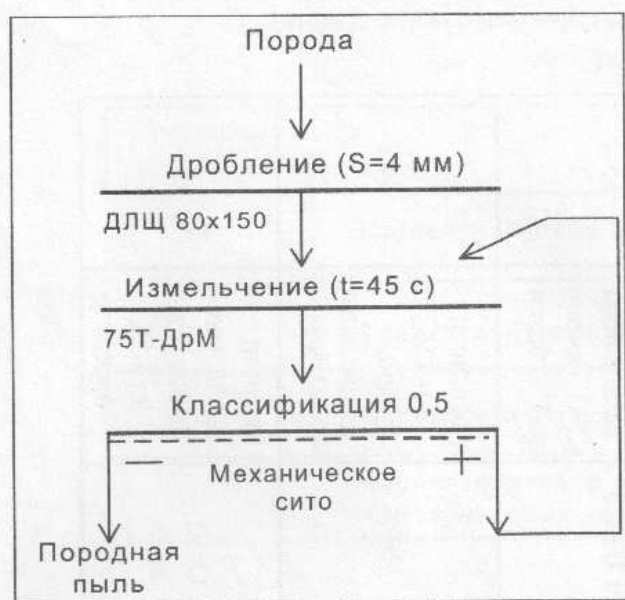
Рис. 2. Схема подготовки породной пыли.
