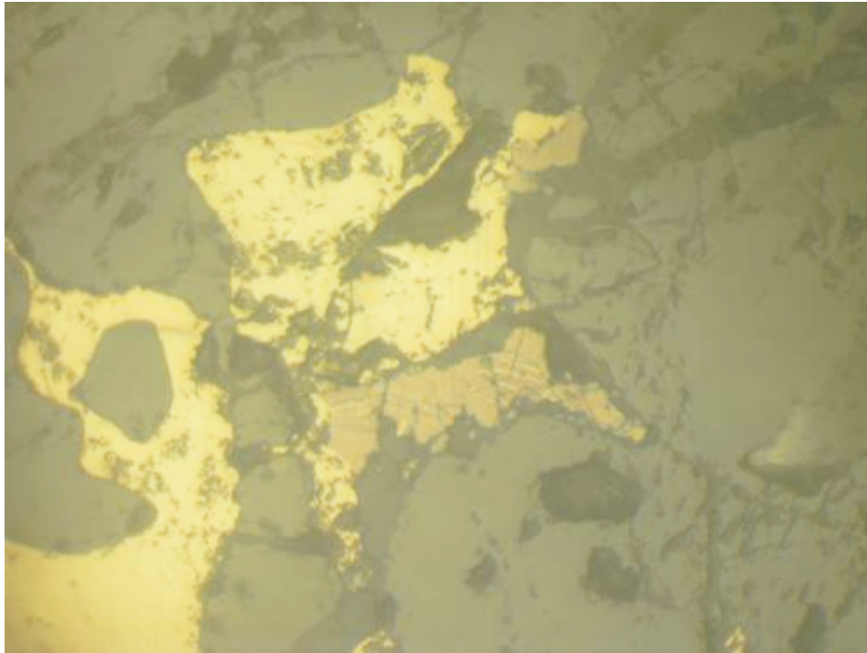
Рис. 8. Сросток халькозина (розоватый) и халькопирита (желтый). В халькозине проявлена микроструктура распада твердого раствора. Полированный шлиф. Увеличение 270 x
