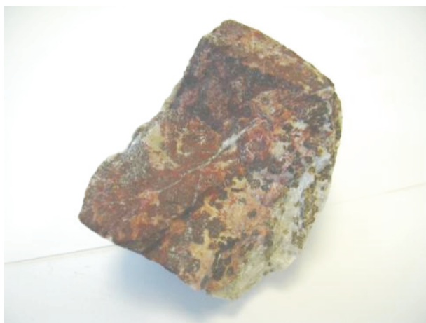
Рис. 2. Волластонит-гранатовый скарн с корками и пылевидной вкрапленностью гематита. Штуфной образец. Увеличение 1,5 x
