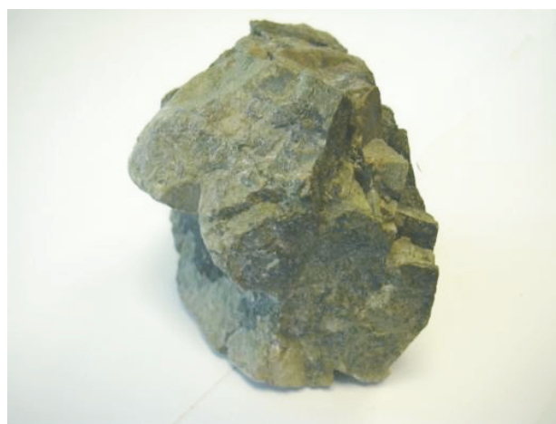
Рис. 3. Катаклазированный диопсид-гранатовый скарн. Штуфной образец. Увеличение 1,5 x
