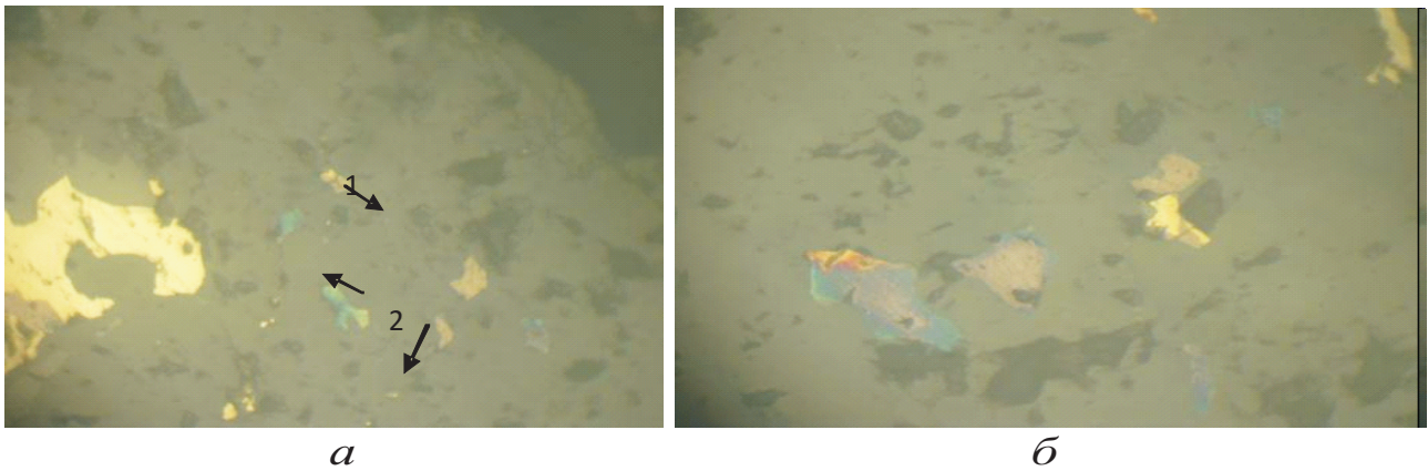
Рис. 6. Халькозин (розоватые зерна) в виде самостоятельных выделений в сростании с халькопиритом (желтое) и борнитом (1). Полированный шлиф. Увеличение 250 x
