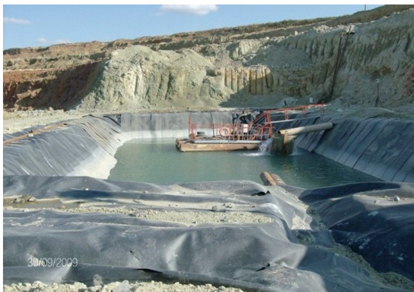
Рис.1. Южный борт карьера. Зумпф-водосборник на горизонте +175 м с плавающей насосной.
