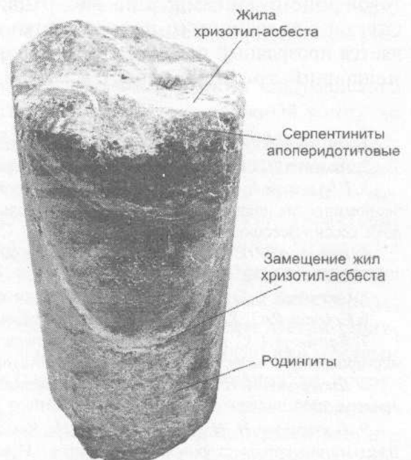
Рис. 2. Замещение жил хризотил-асбеста на контактах даек диоритовых порфиритов (залежь Основная, линия 23 + 00, образец керн, скв. 42, гор. + 35 м)
