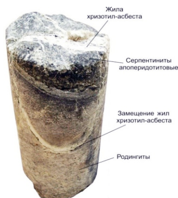
Рисунок 6 – Замещение жил хризотил-асбеста на контактах даек диоритовых порфиритов (залежь Основная, линия 23 + 00, образец керна, скв. 42, гор. + 35 м)
