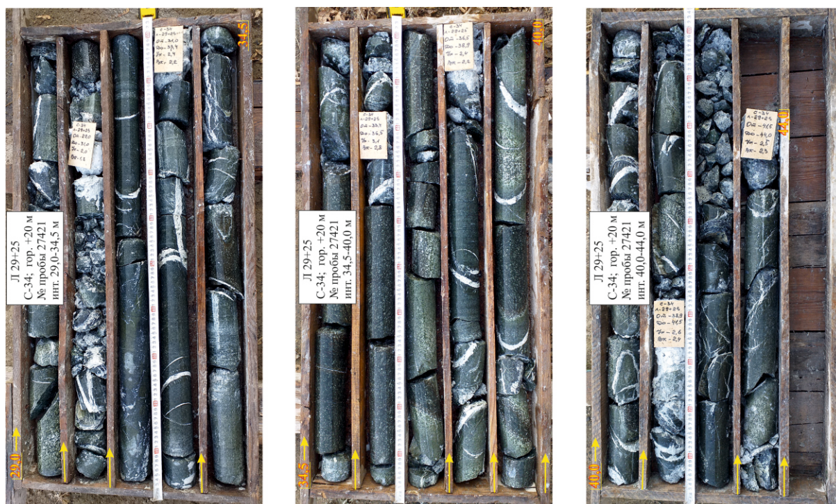
Рисунок – Керновая проба из скважины эксплуатационной разведки Джетыгаринского месторождения хризотил-асбеста южного участка залежи Основная
