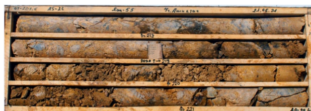
Рисунок 5 – Скважина As-26, глубина 207,6–211,4 м. Содержание золота: 4,59 г/т; 2,99 г/т; 1,54 г/т
