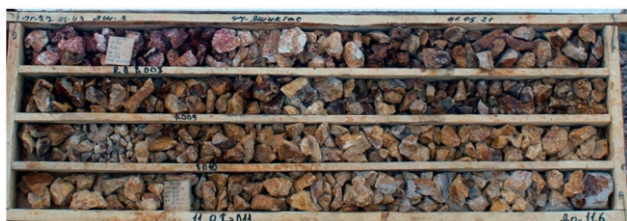
Рисунок 4 – Скважина As-43, глубина 7,7–11,6 м. Содержание золота: 0,96 г/т; 1,09 г/т; 0,91 г/т
