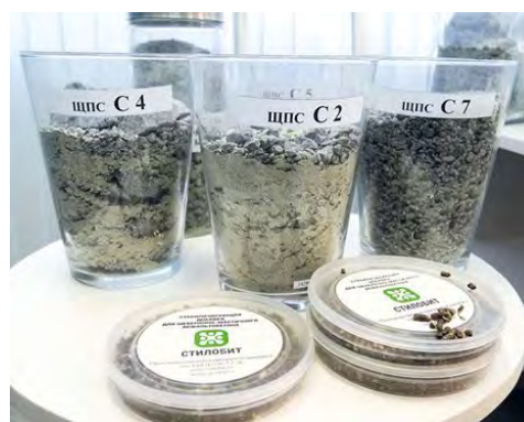
Рисунок 2 – Стабилизирующие добавки в щебеночно-мастичном асфальтобетоне для автомобильных дорог
