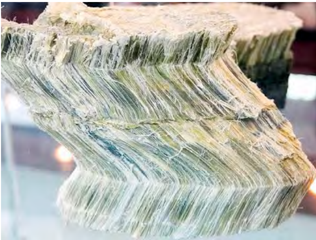
Рисунок 5 – Поперечно-волокнистый тип хризотил-асбеста
