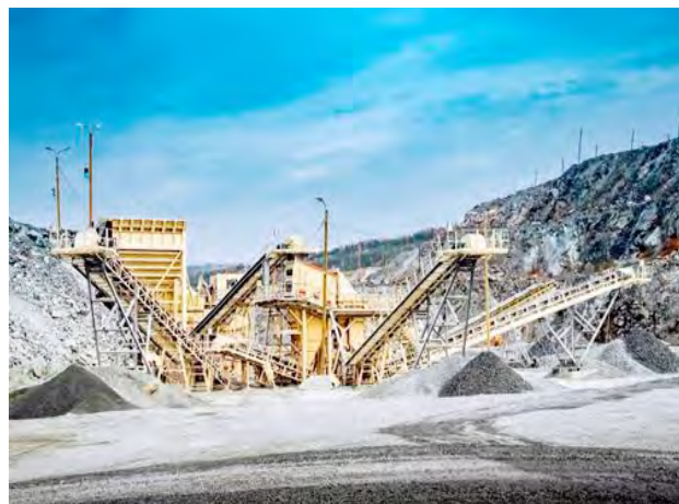
Рисунок 3 – Передвижные дробильно-сортировочные установки компании «Metso»
