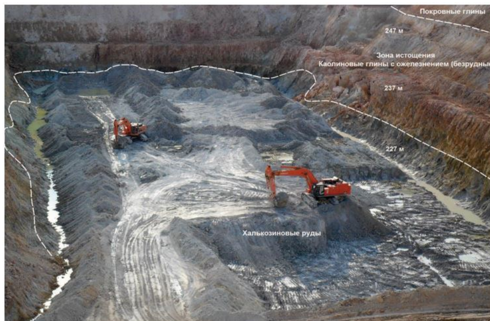
Рисунок 14 – Опытный карьер месторождения Бенкала Видны зоны истощения и вторичного сульфидного обогащения (халькозиновые руды). На рисунке указаны абсолютные высотные отметки. В верхней части халькозиновых руд отмечаются примазки малахита и хризоколлы
