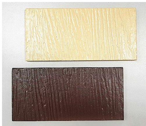
Рисунок 6 – Фиброцементный сайдинг, содержащий хризотилвые волокна с покраской и тиснением
