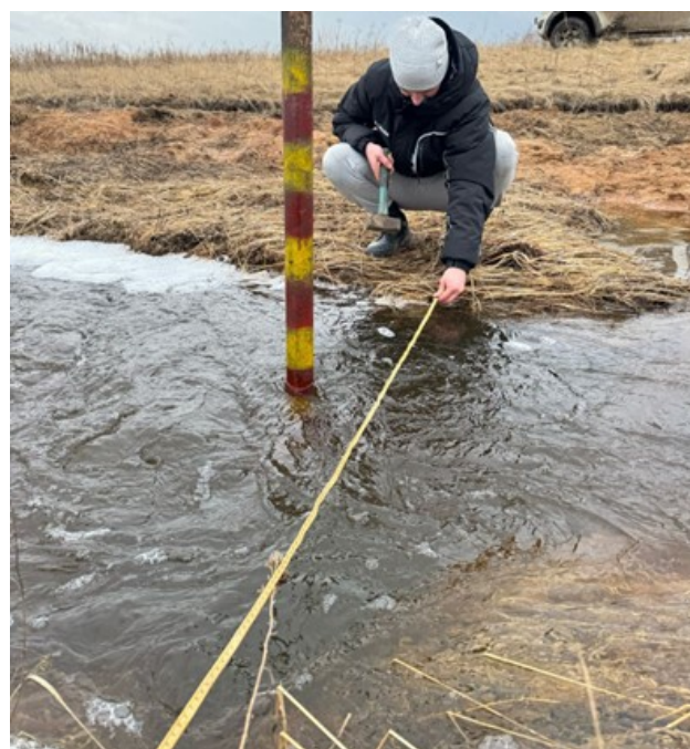
Рисунок 2 – Замер ширины русла «Восточный»
