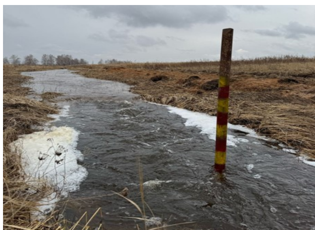
Рисунок 3 – Замер глубины русла «Восточный»
