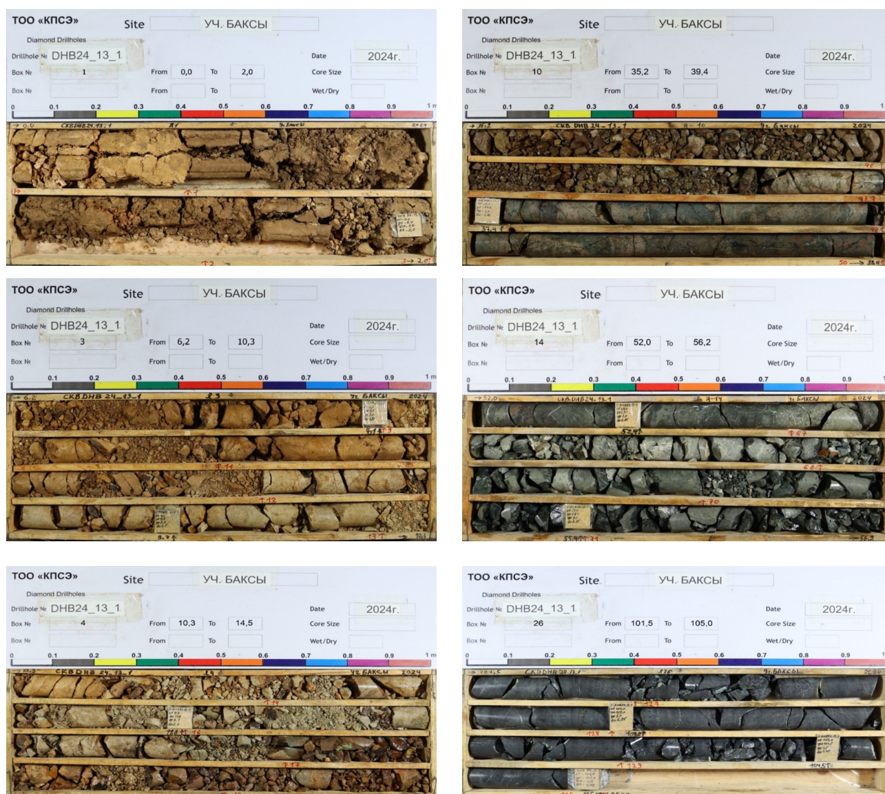
Рисунок 2 – Фотоматериал керна разведочной скважины DGB24-13-1 в центре карьерного поля
